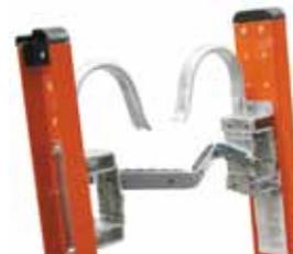
Funciona como gancho de cable y como peldaño en "V". Para uso en aplicaciones donde el diámetro del poste, en el punto de apoyo, no excede 10". El peldaño en "V" de acero tiene cojín de caucho para funcionamiento anti-deslizante. Se incluye un (1) conjunto de gancho de cable y peldaño en "V", herrajes de montaje e instrucciones.
